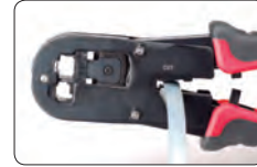
Corte de cables de red
