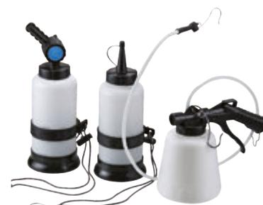
Para extração do fluido dos travões / pinças de travão, pneumático, adequado para travões ABS, fornecido com 2 recipientes
