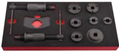
Para montar pistões nas pinças de travão durante a montagem de calços adequado para a maioria dos veículos
