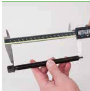
b Mida la longitud de rosca hasta la punta del husillo
