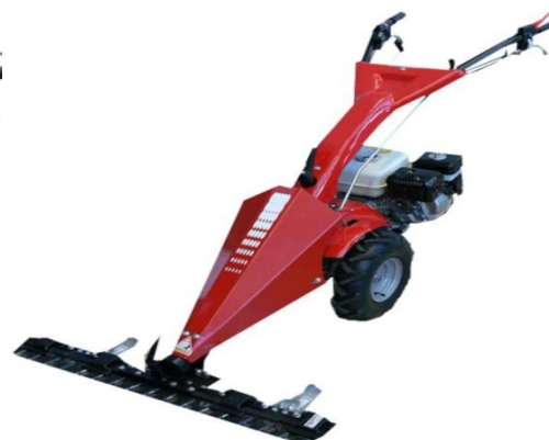
MG.147 Motocultivador / Motogadadeira MAB 204 Motor Honda GX160, 5,5cv Caixa velocidades 2 frente + 2 atrás
