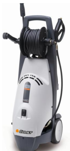
KSME1480 Máquina Lavar com enrolador 2 ponteiros 150 bar, 480Lt/H 2,3kW, 230V Bomba em Latão
