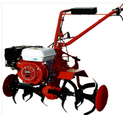
MO.NF1 Motoenxada Mab Formica NF1 Motor Honda GX 2000, 6,5 cv, Gasolina Caixa de velocidades 3 frente + 1 atrás Frese de 100cm
