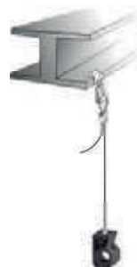
Tubo suspendido por cable
