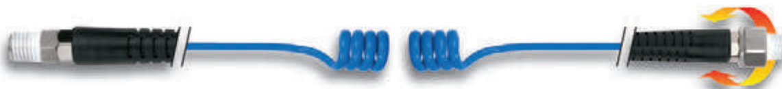
Enchufe rotativo montado sobre cojinete de bolas del lado de la herramienta neumática: rotación fácil incluso bajo presión
